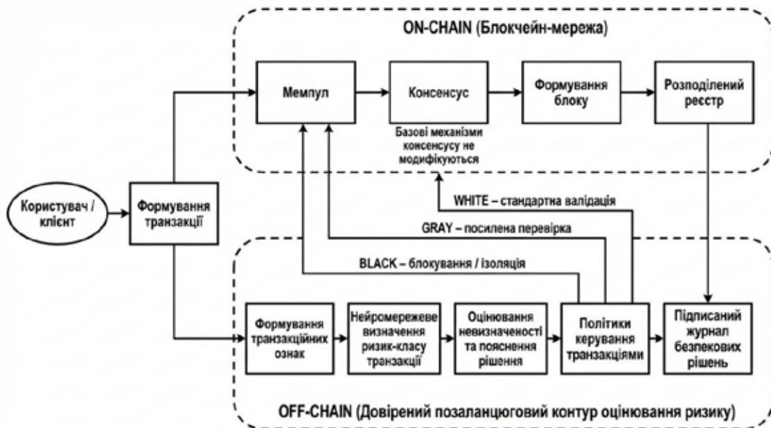
Рис. 1. Архітектура керування захищеними транзакціями в блокчейн-системі з позаланцюговим контуром нейромережевого оцінювання ризику
