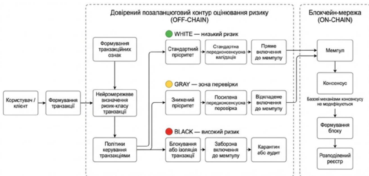
Адаптація виконання транзакцій здійснюється на рівні політик допуску та маршрутизації без зміни алгоритму консенсусу блокчейн-мережі
